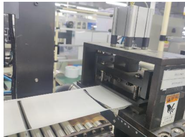
绝缘膜打孔，热贴合铜带，烘烤熟化
