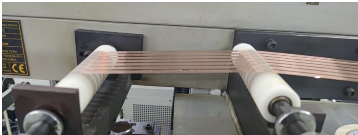
带槽的间距轮将铜导体间距排列
