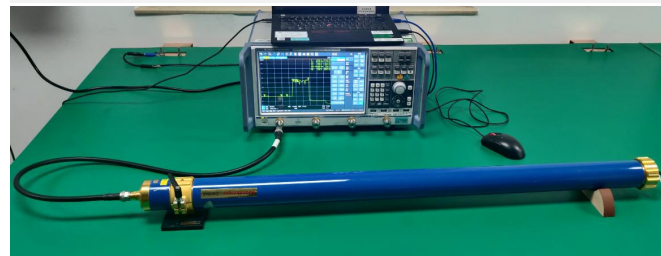
三同轴外电路特性阻抗测试
