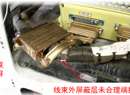
信号地与电源地共用接地螺柱
