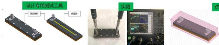
塑胶塑料材料DK值设计了专用测试夹具，用来模拟信号传输环境；通过测量与仿真的工程模拟，得到该频点的材料属性Dk值，其在连接器上应用的准确度远高于常规的腔体法测试。
