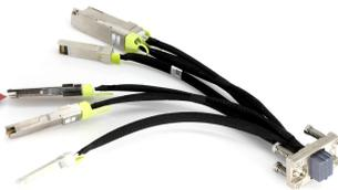
计算节点高速cable连接器
