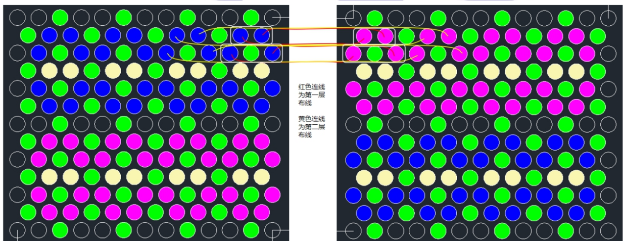
图 43 常规封装小芯片间互连示意图（差分串行 16 接口）
