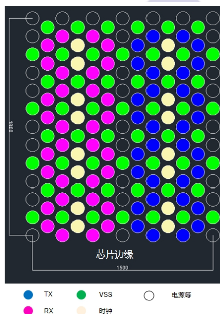
图 39 常规封装小芯片间互连凸点排布示意图（差分串行 16 接口）
