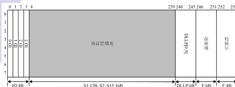
图 13 256 字节 Flit 格式-PCIe
