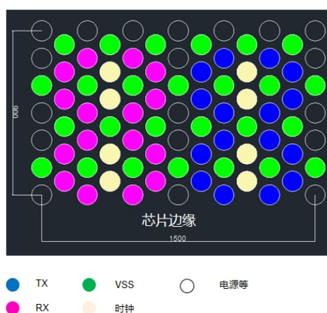
图 38 常规封装小芯片间互连凸点排布示意图（单端并行 16 接口）
